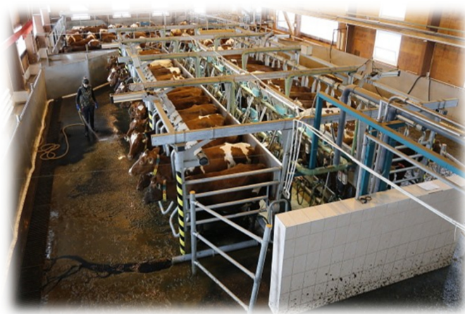
Рисунок 2 – Электронный доильный зал
