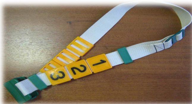
Рисунок 3 – Электронный ошейник для КРС
