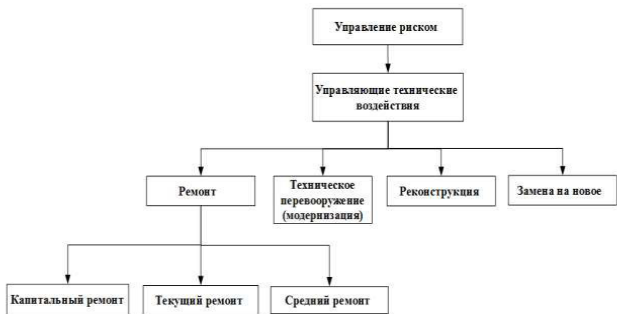
Рисунок 3 – Управление риском выхода из строя сельских электрических сетей посредством управляющих технических воздействий
