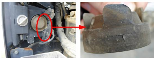
Рисунок 4 – Старение и растрескивание крышек ламп дальнего и ближнего света
