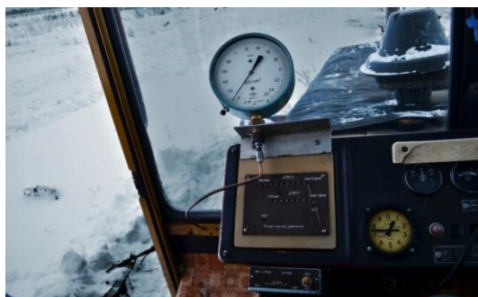
Рисунок 2 – Дополнительные приборы, установленные в кабине трактора во время полевых испытаний
