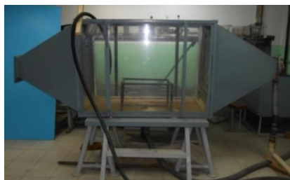
Рисунок 3 – Экспериментальная установка «Гидробассейн»
