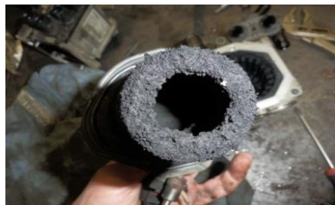
Рисунок 1 – Закоксовывание горелки предпускового подогревателя
