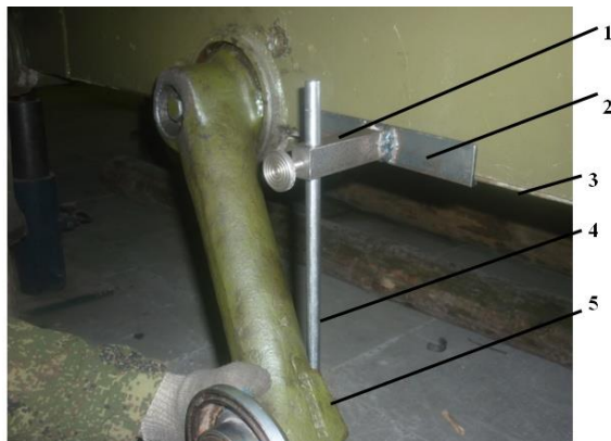
Рисунок 2 – Фиксация балансира относительно кромки борта БМП: 1 – корпус кондуктора; 2 – уголок; 3 – кромка днища; 4 – стержень; 5 – балансир
