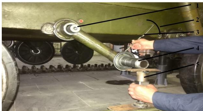
Рисунок 3 – Определение дуги для нанесения насечки 1 – торсионный вал, 2 – дуга; 3 – стрелка, 4 – балансир, 5 – фиксатор балансира
