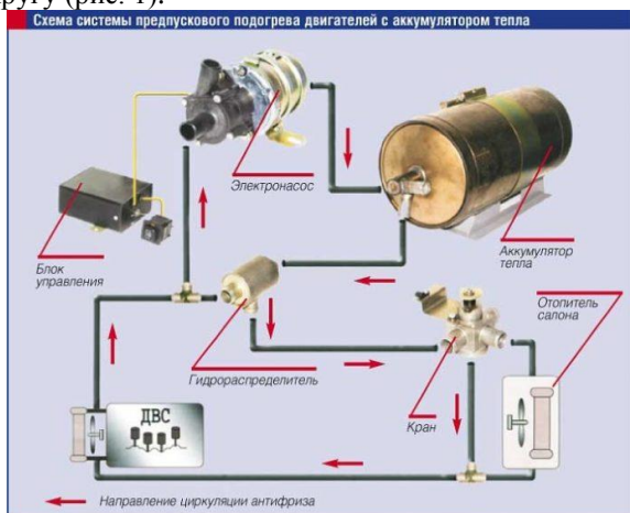
Рисунок 1 – Схема подключения теплового аккумулятора
