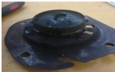
Рисунок 2 – Прогар сетки предпускового подогревателя
