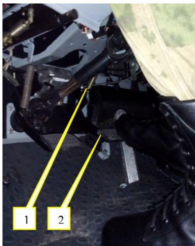
Рисунок 2 – Кабина тренажера ТВМ-Урал: 1 – возвратная пружина; 2 – тормозная педаль
