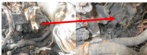
Рисунок 1 – Возгорание автомобиля OpelMokka из-за неисправности электрической цепи управления стартером, выразившаяся в чрезмерно долгом включении стартера
