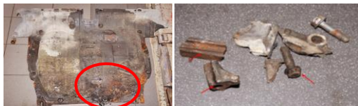
Рисунок 3 – Фрагменты деталей, обнаруженных в пожарном мусоре на защитах двигателя
