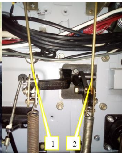
Рисунок 3 – Единый узел педалей: 1 – тяга датчика тормозной педали; 2 – тяга датчика педали сцепления
