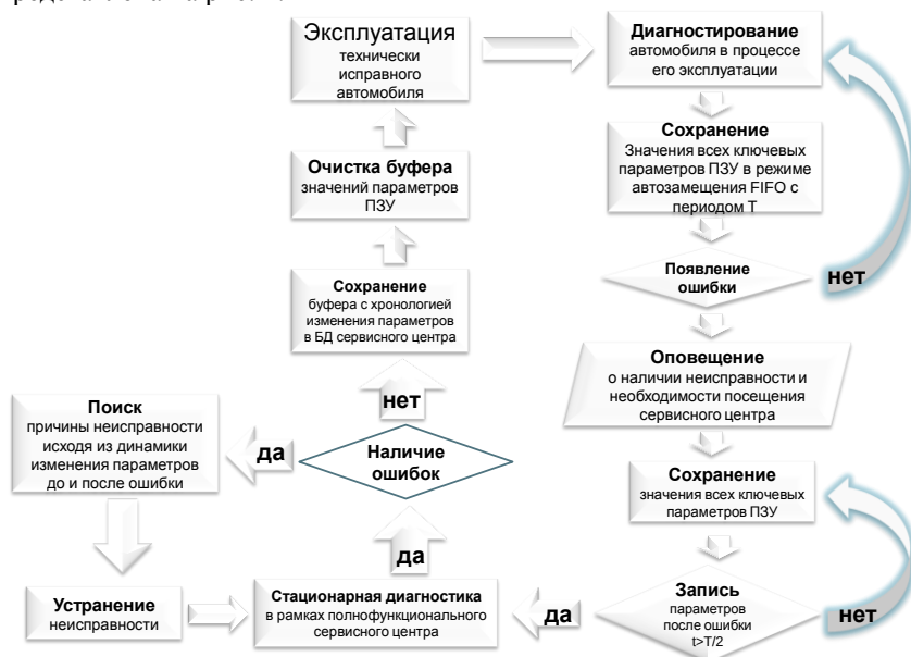
Рисунок 2 – Типичная схема алгоритма диагностирования с циклической записью параметров
