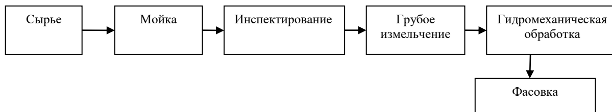
Рисунок 2– Схема технологического процесса гидромеханической переработки овощного сырья
