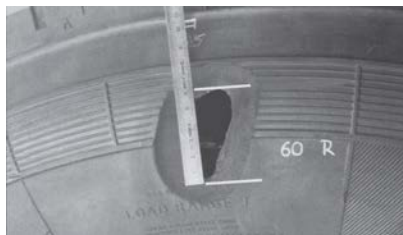
Рис. 4.29. Этапы разработки повреждения шины
