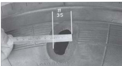
Рис. 4.29. Этапы разработки повреждения шины
