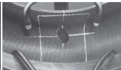
Рис. 4.29. Этапы разработки повреждения шины
