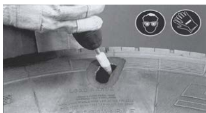
Рис. 4.29. Этапы разработки повреждения шины
