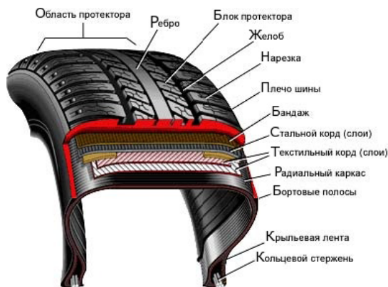
Рис. 4.27. Устройство радиальной шины
