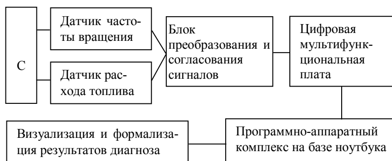
Рис. 2. Блок-схема системы определения мощностных и топливно-экономических показателей автотракторных двигателей
