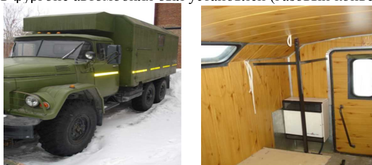
Рис. 2. Место установки газового конвектора
