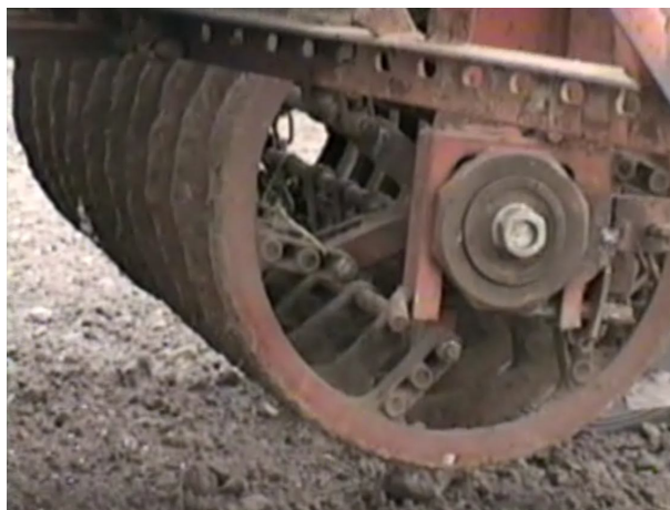
Рис. 3. Конструкция опорного катка примененного в комбинированной машине
