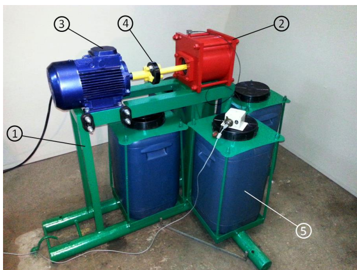
Рисунок 1. Лабораторная установка: 1 – рама, 2 – вибровозбудитель, 3 – электродвигатель, 4 – гибкая муфта, 5 – ёмкости с балластом.
