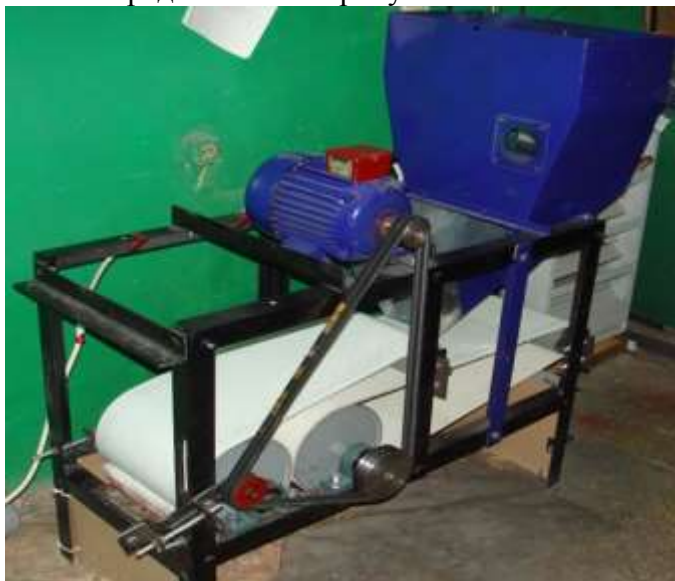
Рисунок 2 - Общий вид лабораторной плющилки зерновой смеси.
