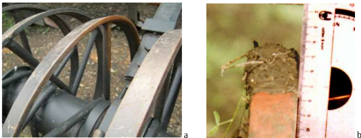
Рисунок 1 — Многооперационные конусные катки: а — внешний вид секции и активная поверхность [1]; б — образование на активной поверхности почвенного ядра [2]
