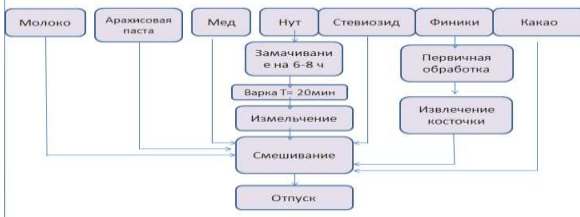
Рис. 4. Технологическая схема производства кондитерского изделия функциональной направленности - нутовая паста
