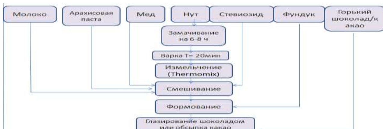
Рис. 5. Технологическая схема производства кондитерского изделия функциональной направленности - конфеты из нута
