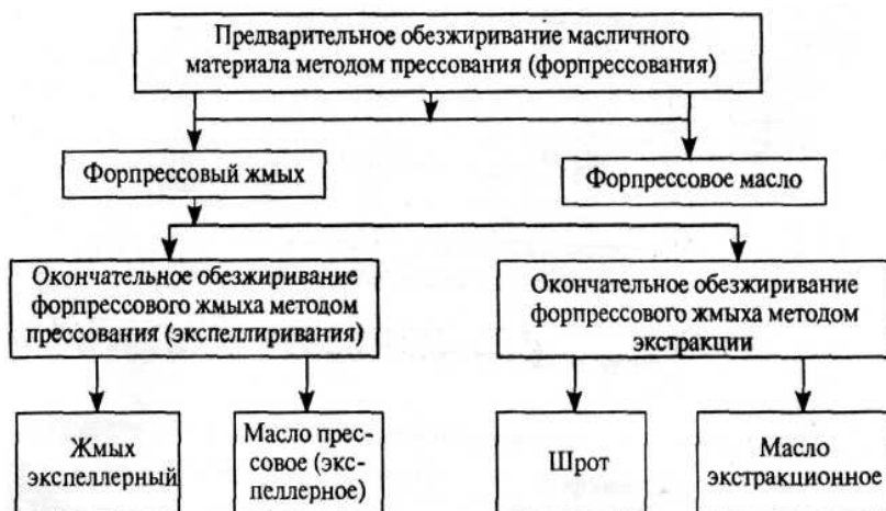
Рис. 3.1. Схема способов получения растительных масел
