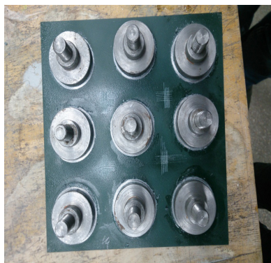
Рис. 1. Испытательная пластина с цилиндрами для определения адгезионной прочности по методу отрыва
