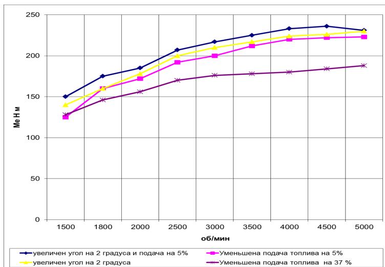
Рис. 2. Изменение крутящего момента двигателя 3МЗ 4062.10, полученные динамическим методом при различных подачах топлива и углах опережения зажигания
