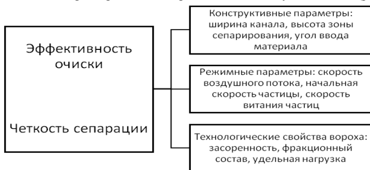
Рис. 1. Основные факторы влияющие на качественные показатели процесса пневмосепарации зернового вороха
