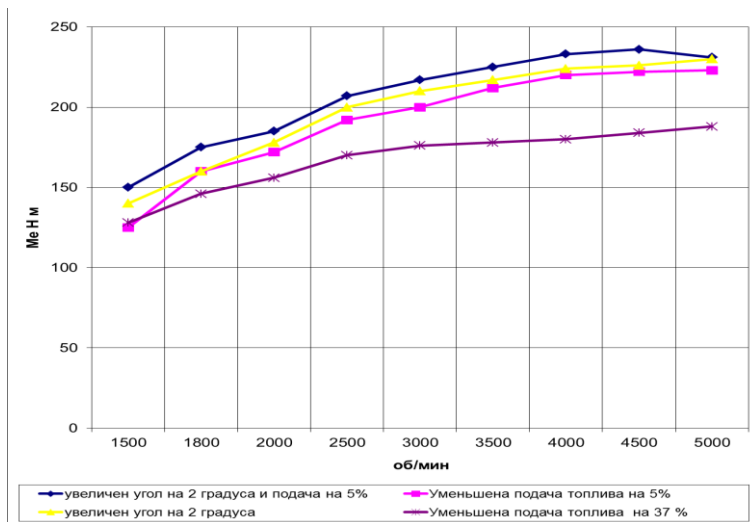
Рисунок 2 - Изменение крутящего момента двигателя ЗМЗ 4062.10, полученные динамическим методом при различных подачах топлива и углах опережения зажигания
