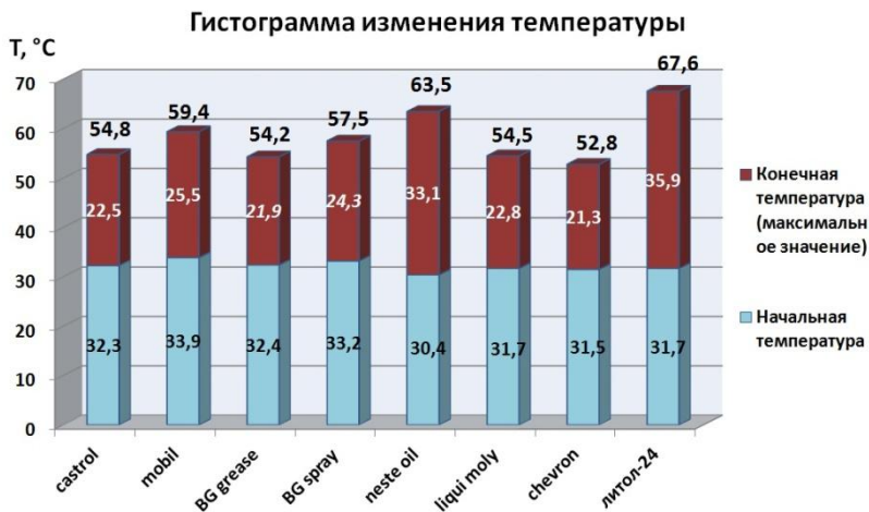
Рисунок 2 – график возрастания температур (средние значения)
