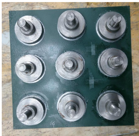
Рисунок 1 – Испытательная пластина с цилиндрами для определения адгезионной прочности по методу отрыва
