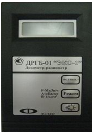
Рис.13. Дозиметр-радиометр ДРГБ-01 «ЭКО-1»
