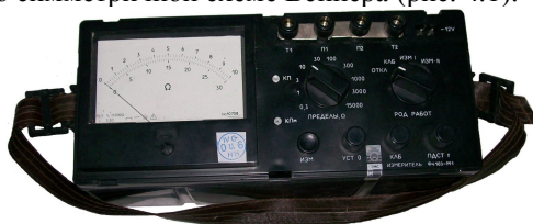
Рис. 4.4. Измеритель сопротивления заземления типа Ф4103-М1 Результаты измерений и вычислений занести в таблицу 4.1:
