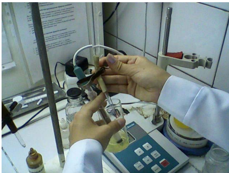
Рис. Титрование до достижения pH 8,1
