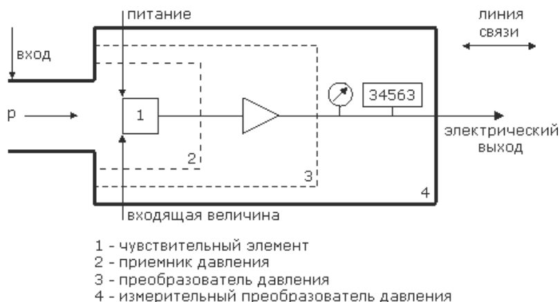
Рис. 1.1 - Блок-схема преобразователя давления в электрический сигнал
