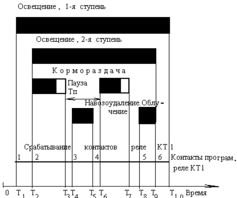
Рис.4.4.Временная диаграмма технологических процессов
