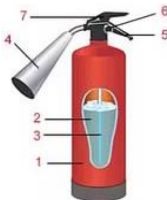
Рис. 4. Конструкция переносного углекислотного огнетушителя
