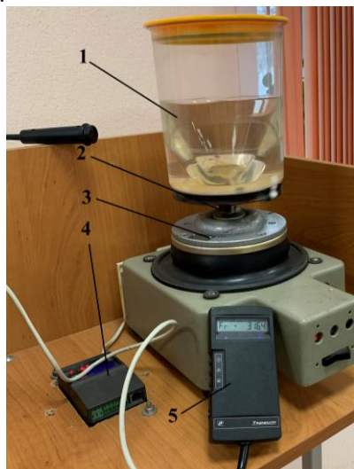
Рисунок 26 – Схема лабораторной установки для исследования относительно покоя жидкости
