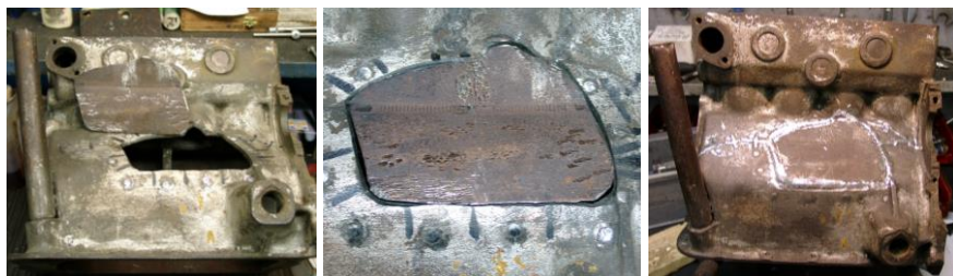
Рисунок 4 – Этапы устранения пробоины в блоке ДВС
