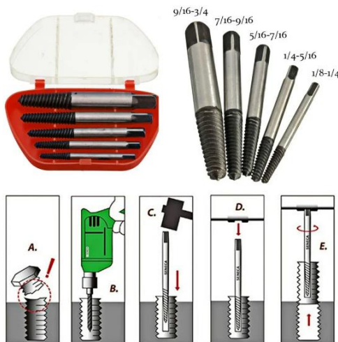
Рисунок 6 – Набор экстракторов и этапы извлечения сорванного болта
