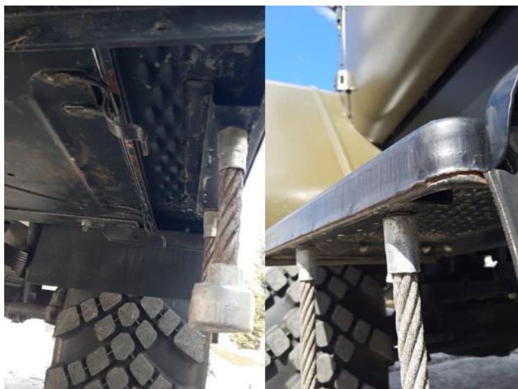
Рисунок 1. Очаги коррозии на автомобиле Урал-4320-0811-31 2023 года выпуска
