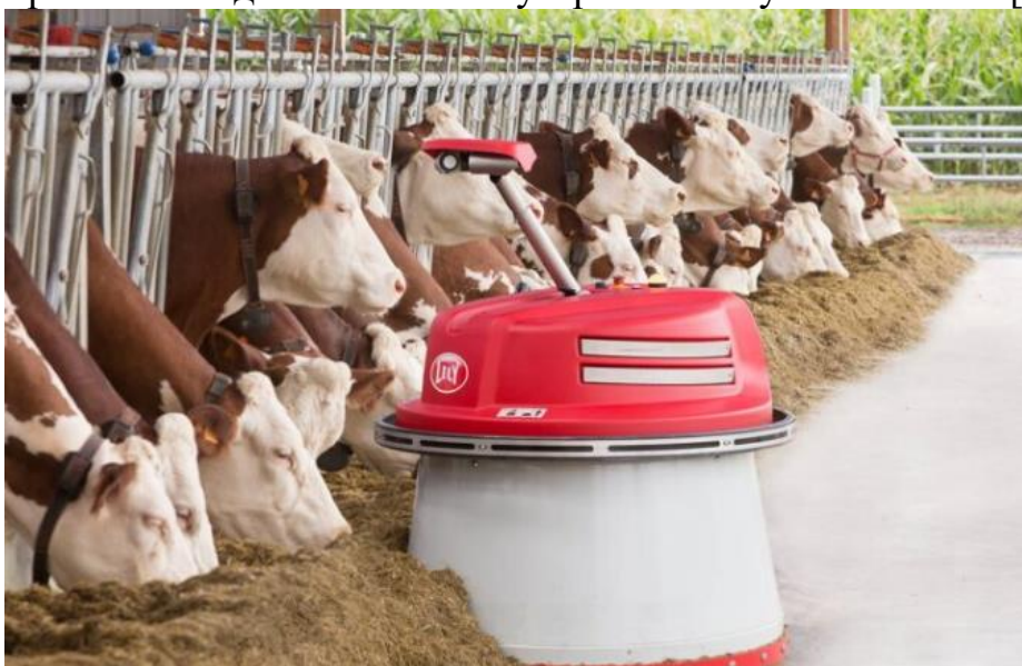
Рисунок 2 – Пододвигатель корма Lely Juno во время работы
