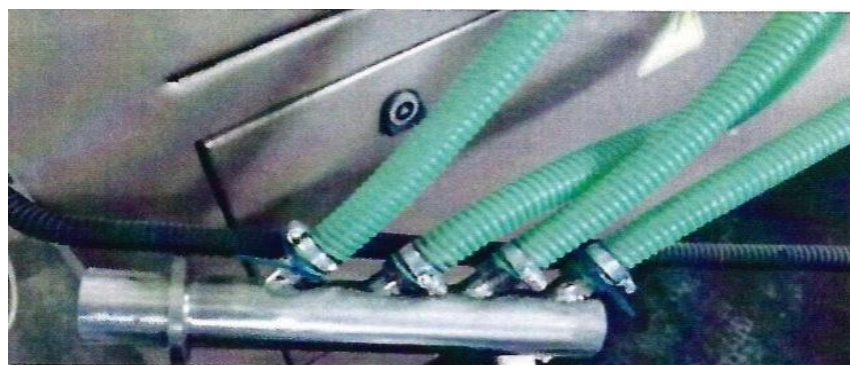
Рисунок 7. Коллектор для подключения щелевого отсоса к аспиратору.
