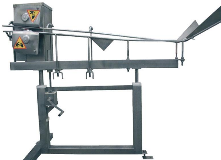
Рисунок 2. - Двухножевое устройство PG-2 для подрезания артерии птицы
