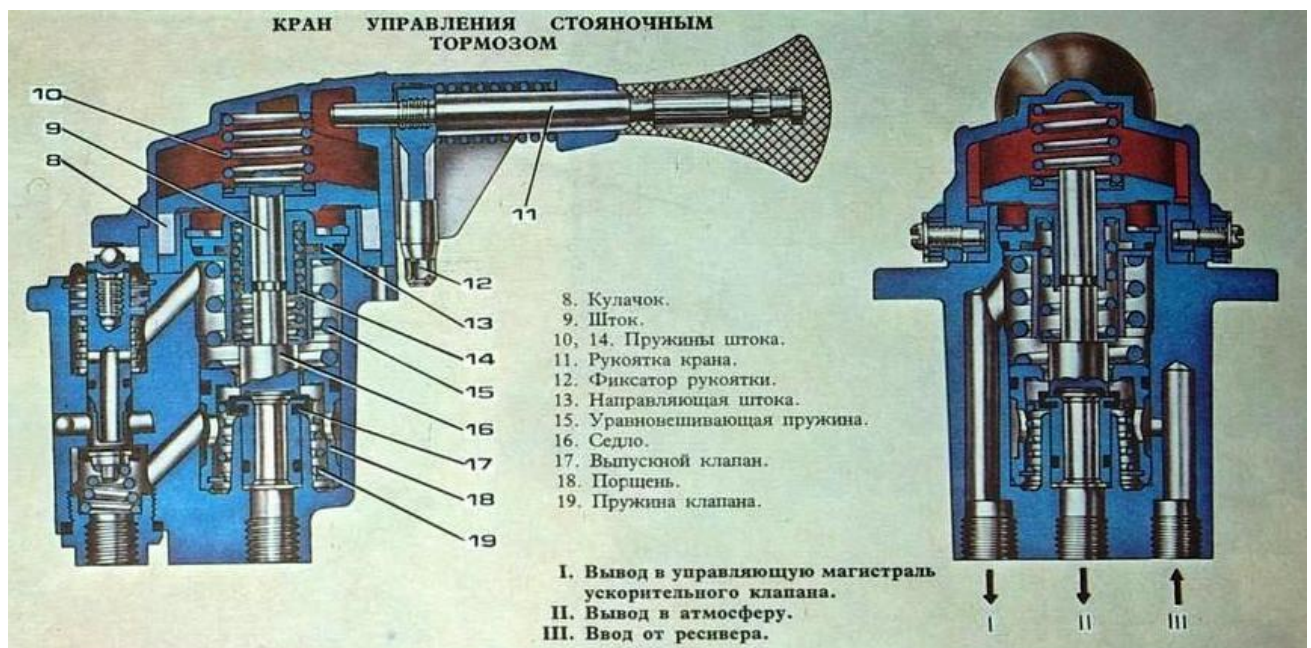
Рисунок 7.2 - Кран управления стояночным тормозом
