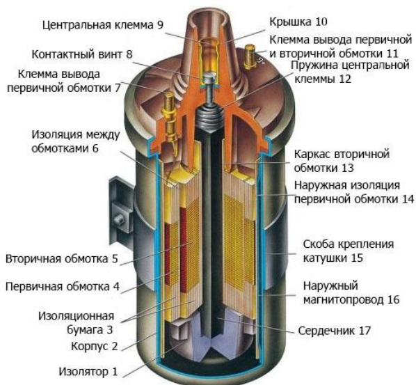
Рис.49 – Устройство катушки зажигания
