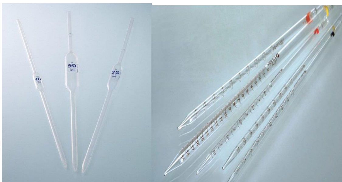
Рис. 12. Пипетки: Мора (а) и градуированные (б)
