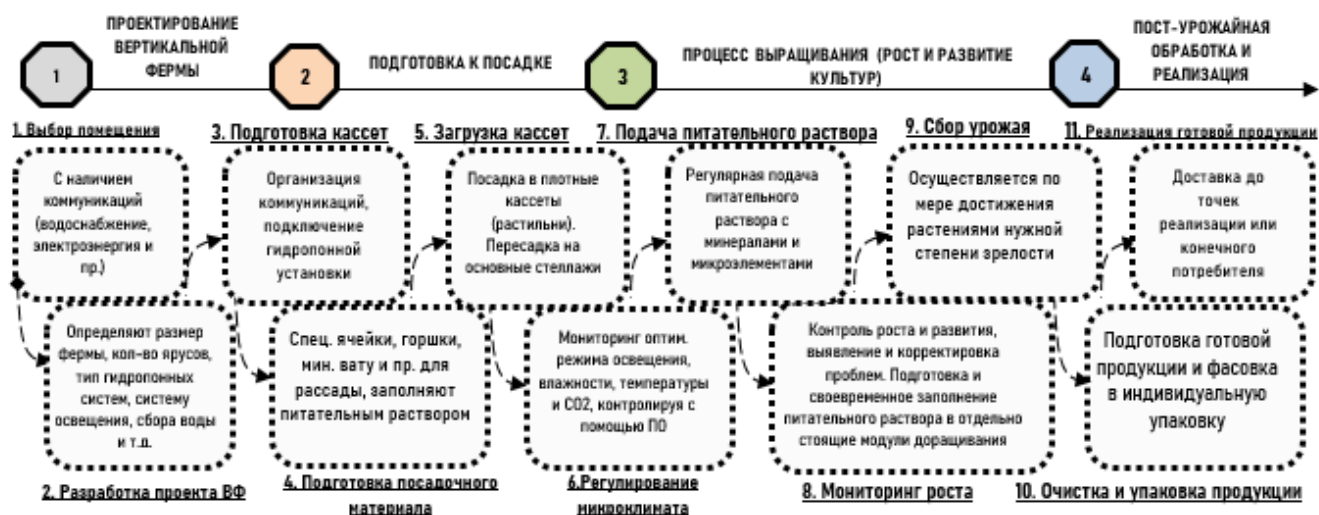
Рисунок 34 – Схема технологического процесса выращивания продукции вертикального фермерства (составлено автором)
