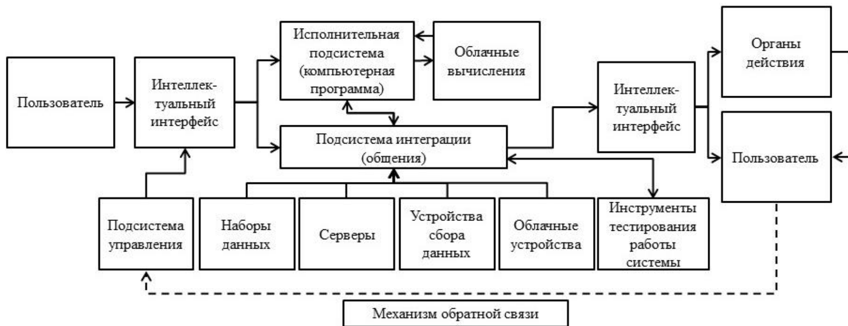
Рисунок 6 – Система искусственного интеллекта в сельском хозяйстве как техническое устройство (техническая система)
