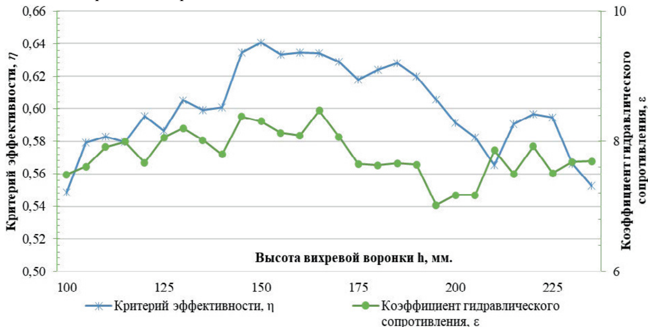
Рис. 6. Критерии эффективности в зависимости от высоты вихревой воронки Efficiency criteria depending on the height of the vortex funnel
