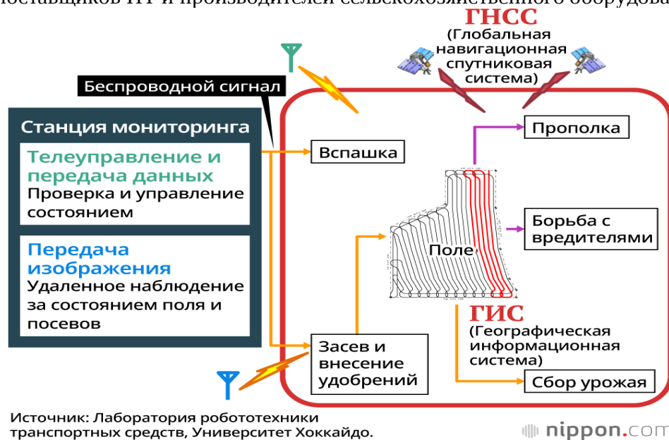
Рисунок 1 – Система удаленного мониторинга сельскохозяйственного оборудования
