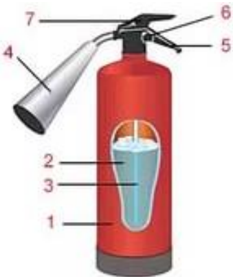
Рис. 5. Конструкция переносного углекислотного огнетушителя:
