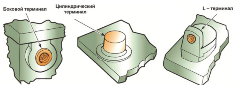
Рисунок 43 – Конструкция полюсных выводов
