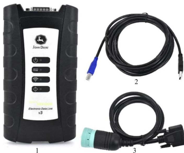
Рисунок 34 – Диагностический сканер John Deere в комплекте:
