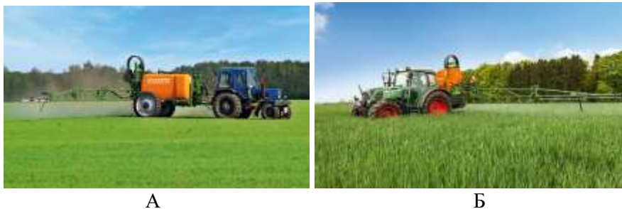
Рисунок 2 – Модельный ряд опрыскивателей компании Amazone: А – прицепной опрыскиватель UG; Б – навесной опрыскиватель UF
