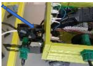
Рисунок 11 – Имитация неисправности вентилятора пневматической высевающей системы
