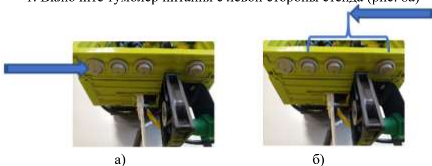
Рисунок 8 – Тумблеры питания элементов стенда
