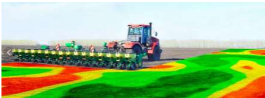
Рисунок 4 – Дифференцированный посев по карте заданию
