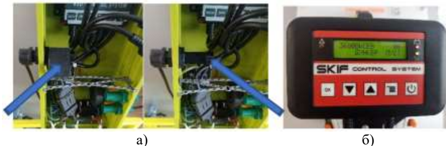
Рисунок 13 – Имитация отсутствия семян в бункере
