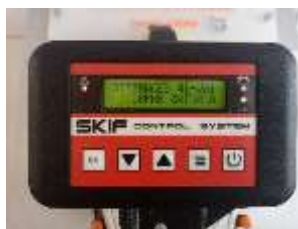
Рисунок 12 – Имитация разрыва цепи системы высева
