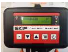
Рисунок 11 – Имитация неисправности вентилятора пневматической высевающей системы
