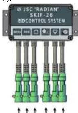
Рисунок 7 – Блок сбора данных БСД-26
