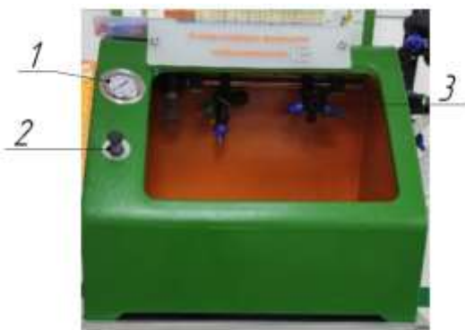
Рисунок 5 – Стенд для проверки форсунок опрыскивателя: 1 – манометр давления в штанге; 2 – регулятор давления; 3 – держатель форсунок.
