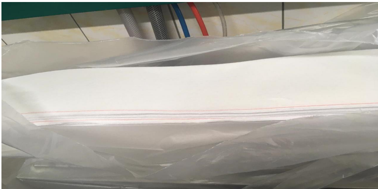
Рисунок 13. Чулочный фильтр для очистки молока
