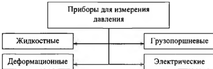
Рисунок 4 – Виды приборов для измерения давления по принципу действия
