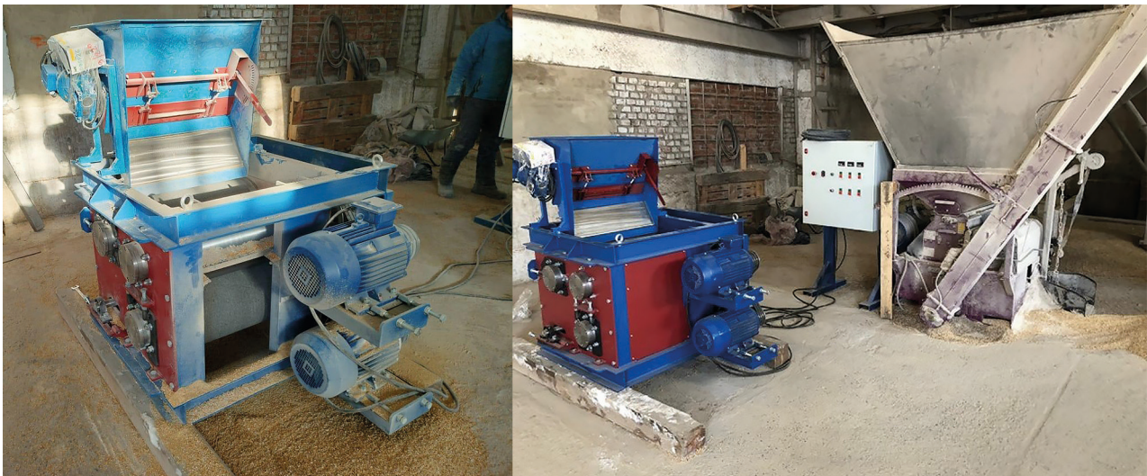
Проведение производственных испытаний вальцово-ленточной плющилки
