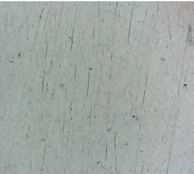
покрытие с нано (рез испыт на изгиб)
