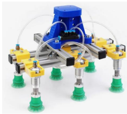
Рисунок 3. Манипулятор и пневматический захват.
