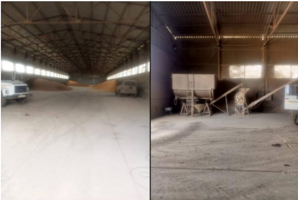
Рисунок 1. - Молотковая дробилка с бункером дозатором и расположение зерна в ангаре
