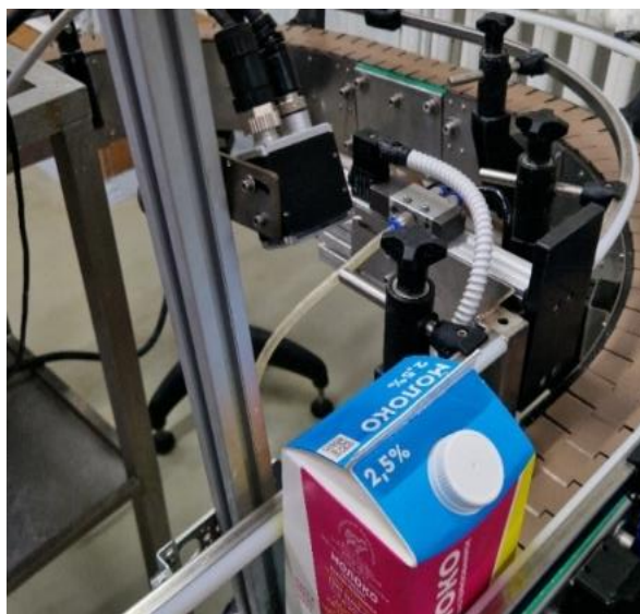
Рисунок 1. Считывающая камера над транспортерной лентой
