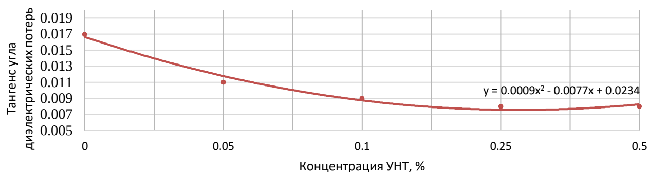
Рисунок 2 — Зависимость изменения тангенса угла диэлектрических потерь от концентрации УНТ в составе ЛКМ
