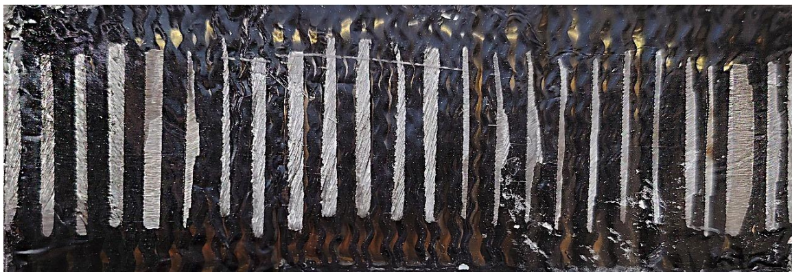
Рисунок 3 — Образцы покрытий Ti–TiO x на бетоне после фиксации в оснастке и заливки эпоксидной смолой
