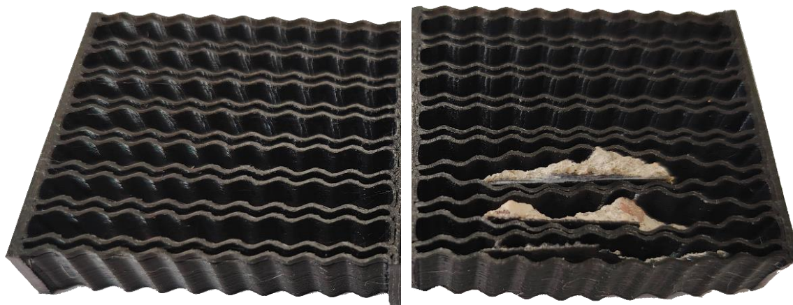
Рисунок 2 — Напечатанная оснастка при помощи FDM-принтера для пакетной подготовки образцов покрытий к механической обработке: а — напечатанный экземпляр; б — экземпляр с установленными образцами покрытия
