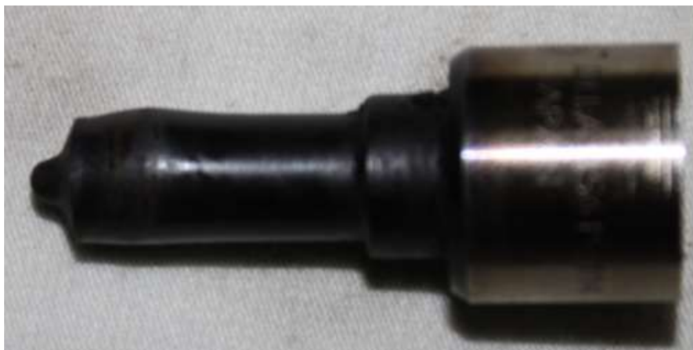
Рис. 1 Повреждение распылителя форсунки топливной системы типа Common Rail при попадании воды.
