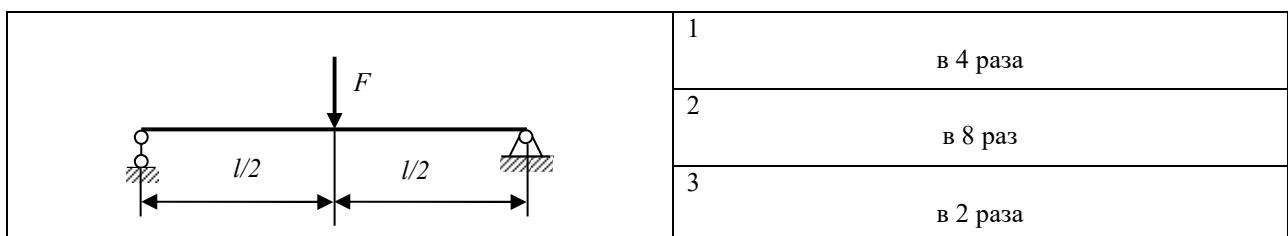
**7.5 Во сколько раз увеличится максимальное значение касательных напряжений в прямоугольном сечении балки, если ширину и высоту сечения уменьшить вдвое?**
