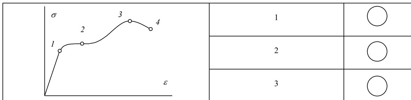
**1.2 Хрупкий материал имеет значение остаточного относительного удлинения при разрыве  $\delta$ :**
