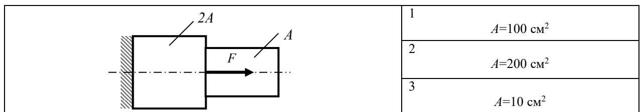
3.4 Определить допускаемую нагрузку  $F$ , если  $A=10\text{см}^2$ ,  $[\sigma]_p=10\text{МПа}$ .
