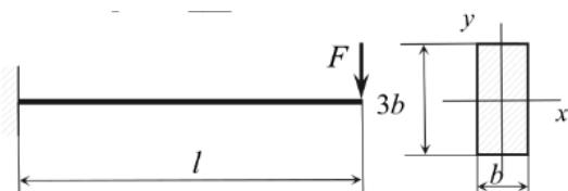
9. Балка нагружена силой  $F = 6 \text{ кН}$  и моментом  $M = 2 \text{ кН}\cdot\text{м}$ . Размер  $l = 0,5 \text{ м}$ ,  $b = 10 \text{ см}$ . Значение максимального нормального напряжения в балке равно \_\_\_\_\_ МПа.
