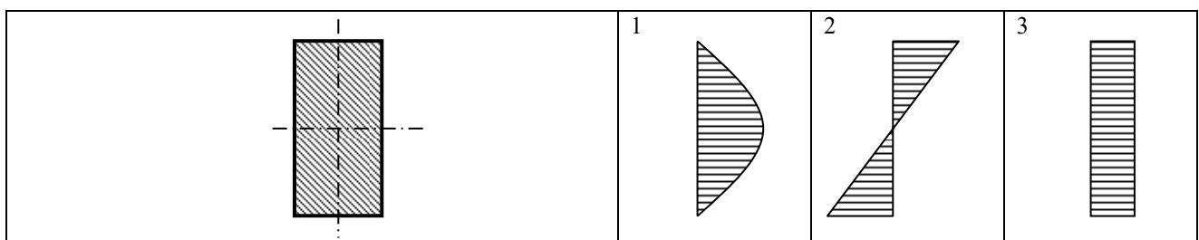
7.2 Укажите правильную эпюру касательных напряжений в сечении балки при ее изгибе в вертикальной плоскости.
