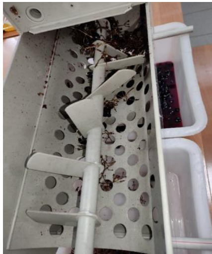
Рисунок 3 –Рабочая камера гребнеотделителя заводского вала с лопастями
