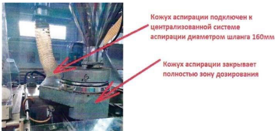
Рисунок 2. Существующая схема аспирации зоны дозирования.
