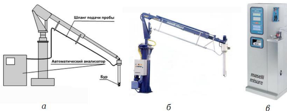
Рисунок 1. Анализатор винограда: а – схема пробоотборника; б – пробоотборник; в – анализатор.
