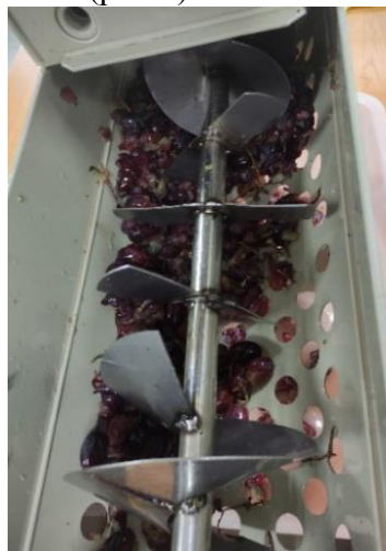
Рисунок 5 –Рабочая камера гребнеотделителя вала с тремя шнеками
