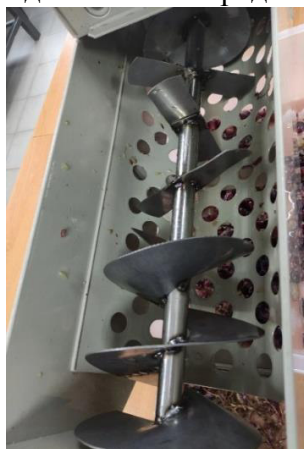
Рисунок 7 –Рабочая камера гребнеотделителя вала с двумя шнеками
