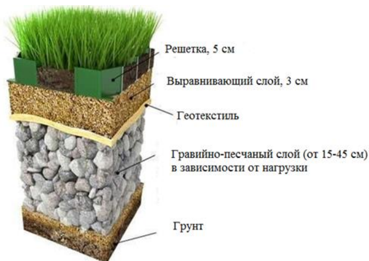
Рис. 4. Профиль экопарковки
