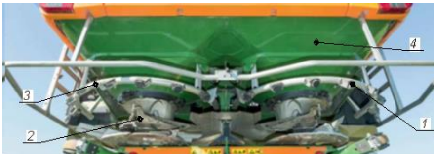
Рисунок 1 – Разбрасыватель удобрений Amazone ZA-TS 3200: 1 – датчик-радар; 2 – разбрасывающий диск; 3 – защитная рамка; 4 – бункер для удобрений
