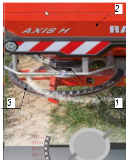
Рисунок 2 – Разбрасыватель удобрений RAUCH AXIS H: 1 – разбрасывающий диск; 2 – бункер для удобрений; 3 – датчик-радар
