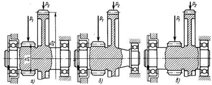
Укажите схему зубчатой передачи с неравномерным распределением нагрузок на опоры
