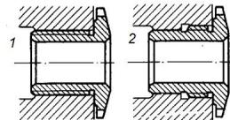
Укажите целесообразное центрирование резьбовых соединений с введением дополнительных центрирующих поверхностей:
