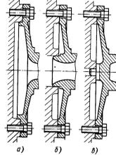
Укажите схему центрирования конструкций при снижении температурных деформаций по наименьшему диаметру
