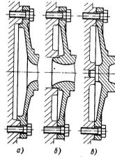
Укажите схему центрирования конструкций при снижении температурных деформаций по промежуточному диаметру
