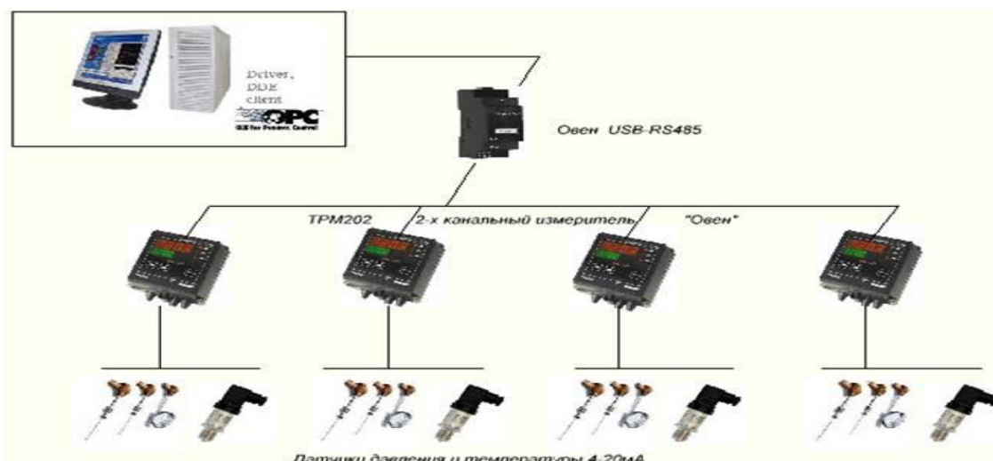
Рисунок 2 – Автоматизированная система регистрации параметров
