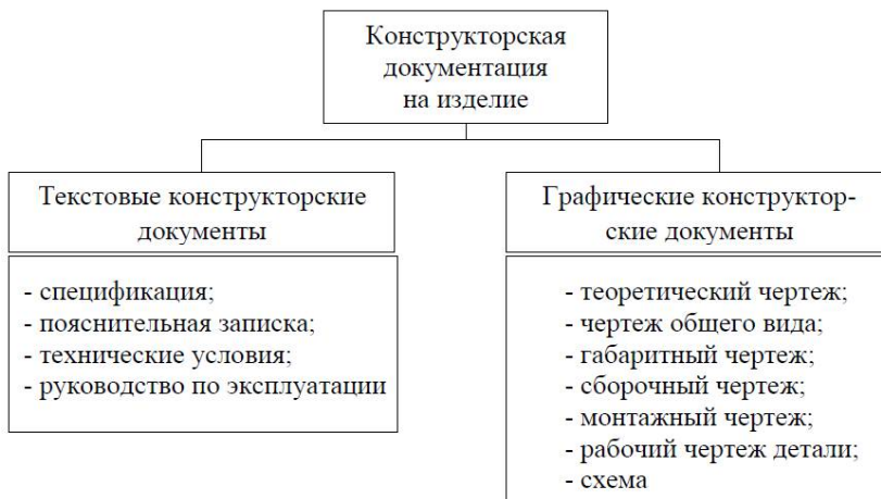
Рисунок 5 – Типовой состав конструкторских документов на изделие
