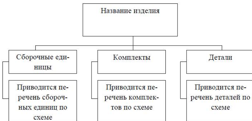
Рисунок 4 – Образец выполнения структурной схемы изделия.
