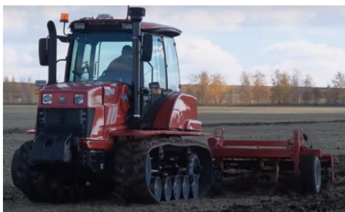
Рис. 1. Испытания пахотного агрегата (трактор “Фермер РБ -2103” + чизельный плуг ПЧН-5 КТ)
