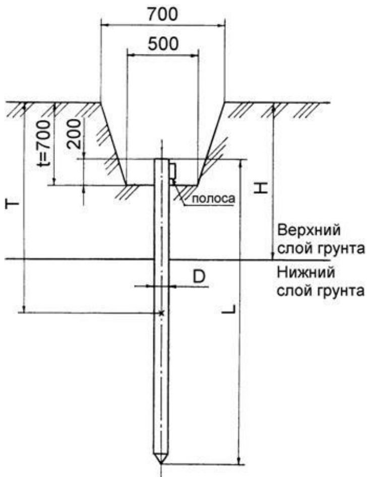
Рис. 7.1 Общий вид вертикального заземлителя.
