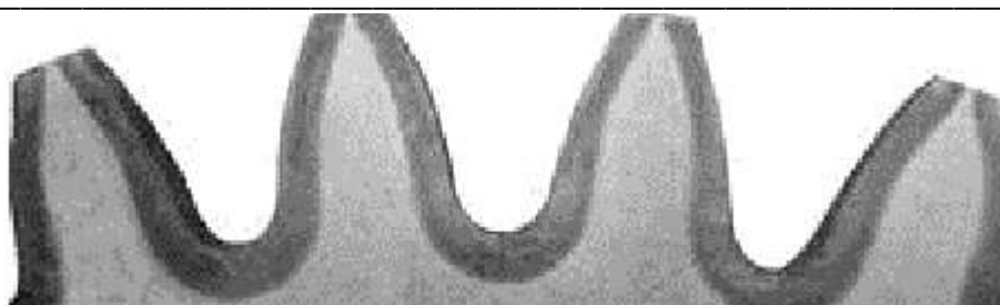
Рис. 3. Макроструктура закаленной детали
